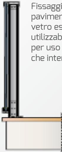
Fissaggio a pavimento con vetro esterno, utilizzabile sia per uso esterno che interno.
