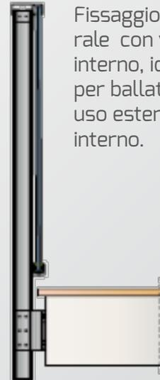
Fissaggio laterale con vetro interno, ideale per ballatoio in uso esterno e interno.
